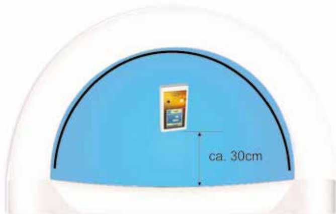
Messung Unterteil Solarium Oberteil abdecken
