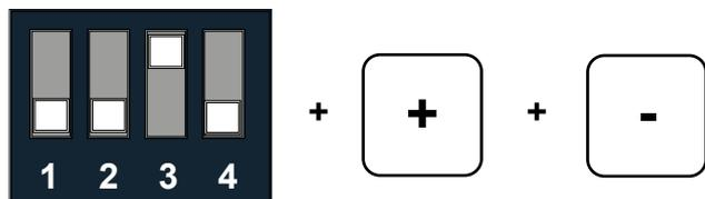
= Durch gleichzeitiges Betätigen der PLUS- und MINUS-Taste wird, wenn der DIP-Schalter Nr. 3 auf "on" (nach oben) gesetzt wurde, im Statistikmenü die angezeigte Statistikposition gelöscht.
