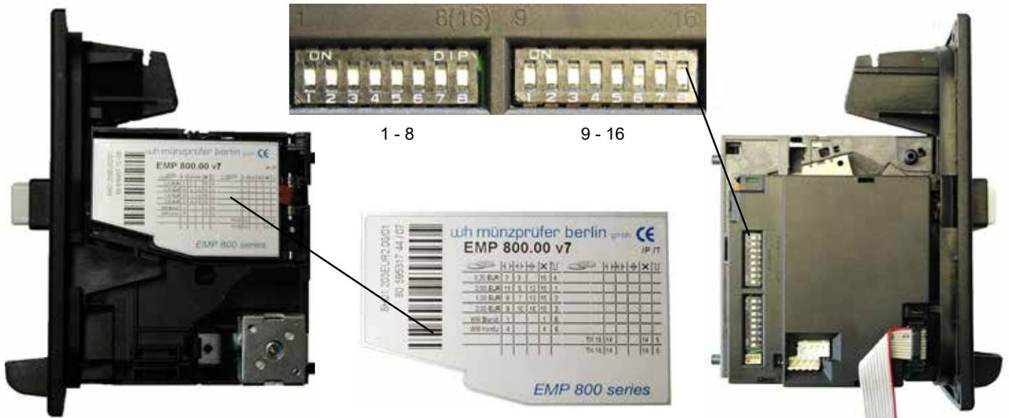
Das Sperren und Freischalten einzelner Münzsorten erfolgt über bestimmte DIP-Schalter-Kombinationen. Es existieren 16 DIP-Schalter, die nach der obigen Darstellung durchnummeriert sind.
