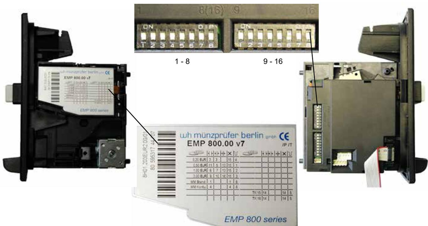
Das Sperren und Freischalten einzelner Münzsornten erfolgt über bestimmte DIP-Schalter-Kombinationen. Es existieren 16 DIP-Schalter, die nach der obigen Darstellung durchnummeriert sind.
